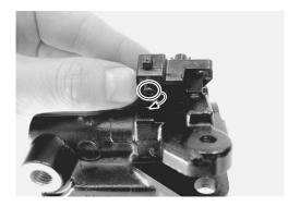
Apply SUZUKI SILICONE GREASE to the brake lever pivot bolt.
